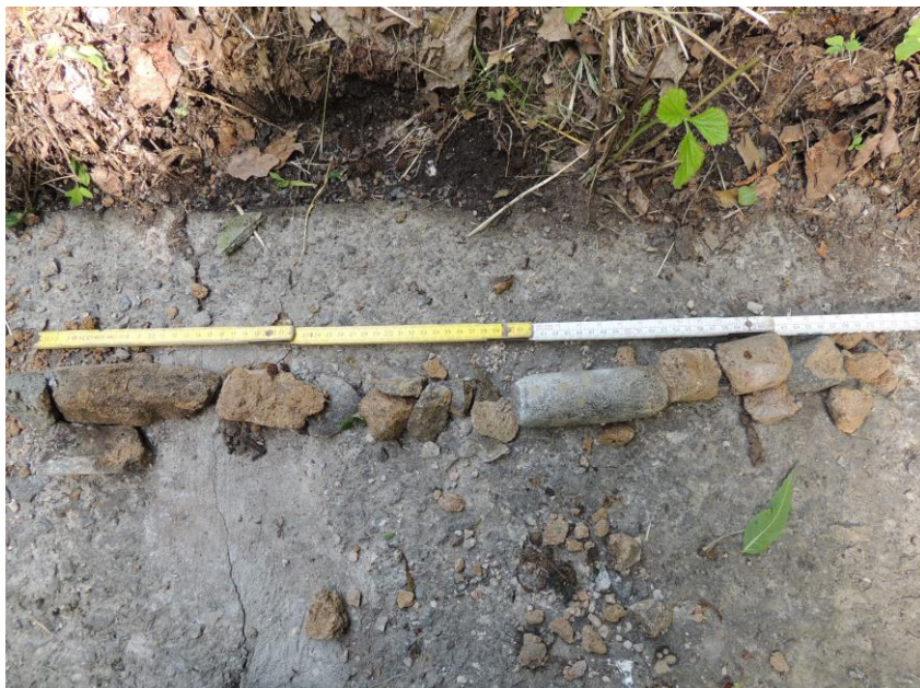
Výtažek ze sondovacího vrtu do levé opěry
