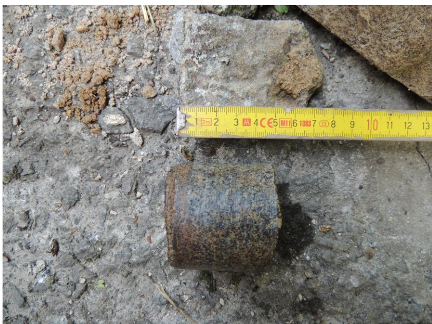
Odebraný vzorek kamene z pravé opěry
